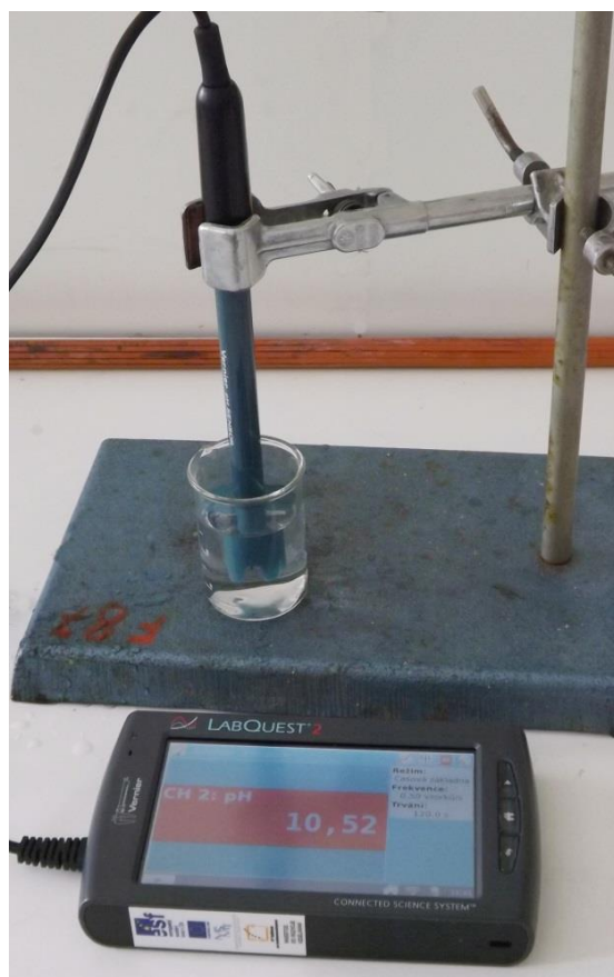
Příklad určení pH roztoku NaOH
