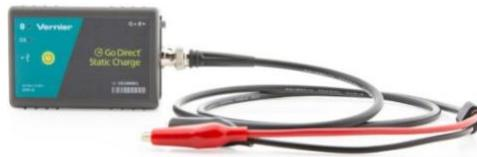
Go Direct senzor statického náboja sa používa ako elektronický elektroskop. Na rozdiel od tradičného elektroskopu, s Go Direct senzorom statického náboja môžete robiť kvantitatívne merania. Číselné merania vylepšia mnohé elektrostatické experimenty, napríklad nabíjanie indukciou, nabíjanie trením a nabíjanie dotykom. Senzor sa dá použiť aj na stanovenie polarity náboja.
